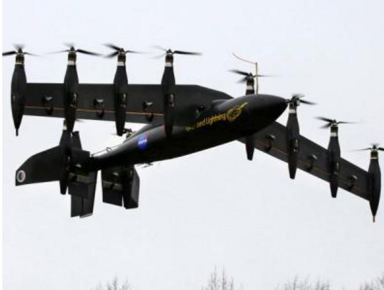
Un equipo de investigadores de la NASA ha ideado una aeronave no tripulada que utiliza un sistema de propulsión eléctrica para despegar como un helicóptero y volar como un avión convencional.
